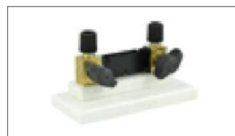
207030500 : 0.001 ohm shunt, 0.5%, 50A max
